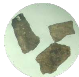
Figura 4: Cacos de eternit do telhado da primeira escola registrado no dia da oficina
